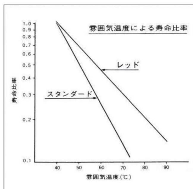
上のグラフは、雰囲気温度が常温時のベルト平均寿命を1.0としたときの雰囲気温度とベルト寿命の関係を表したものです。
