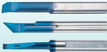
BMK (MT8) は、超微粒子超硬にAITiNの多層コーティング (K10-K20) を施した新型ブルーコーティングです。耐熱性に優れ、中速域で切れ味の鋭い高性能を発揮します。すべての材質に適合する万能材種で、価格はBXCの10%アップ (×1.1) となります。在庫品ではございませんので、ノガ・ジャパンまで納期をご確認下さい。
