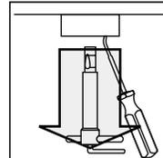
3. パンチ抜き工具を挿入して引き抜きます。
