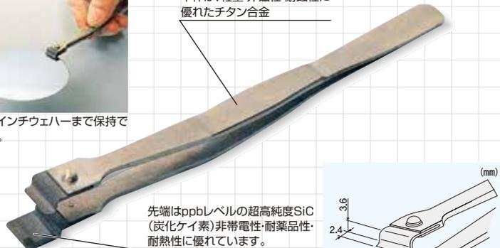
先端はppbレベルの超高純度SiC(炭化ケイ素)非帯電性・耐薬品性・耐熱性に優れています。
