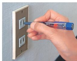
通電していればLEDが点灯します
