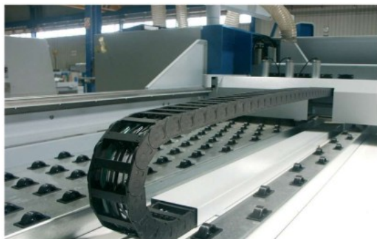
木材加工用に使われたチェーンフレックスCF130.UL。エナジーチェーン：E4/ライト
