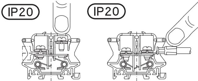
フィンガープロテクト端子台は、安全性を重視した、端子カバー不要の端子台です。端子充電部の露出をなくしたフィンガープロテクト構造となっていますので、安全性を高めたい場合に最適です。
