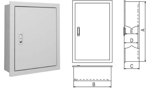
**フカサ 100mm** (ドア下有効フカサ (D) BXU: 70mm FXU: 80mm      ハンドル下有効フカサ (E) BXU: 50mm FXU: 60mm)
