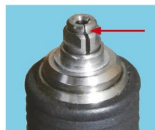
コレットとスリーブコレットの スリットを合わせて下さい。
