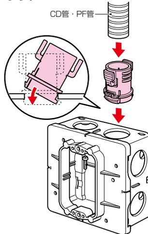
(注1) 埋込四角アウトレットボックス(極薄型)大形四角用、埋込スイッチボックス(極薄型)、コンクリートボックスのバックプレートには取り付けません。
