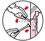
コンクリート打設後、ボックスが多少傾いても器具取り付け位置の修正が可能です。(予備ナット部付)
