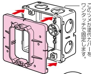
※塗代カバーを外す時は、(+)ドライバーをツメの位置に差し、こじるようにして外してください。
