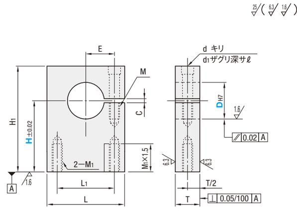
取付穴Dは許容差H7で加工後スリット加工をします。加工によってはH8程度に開く場合があります。
