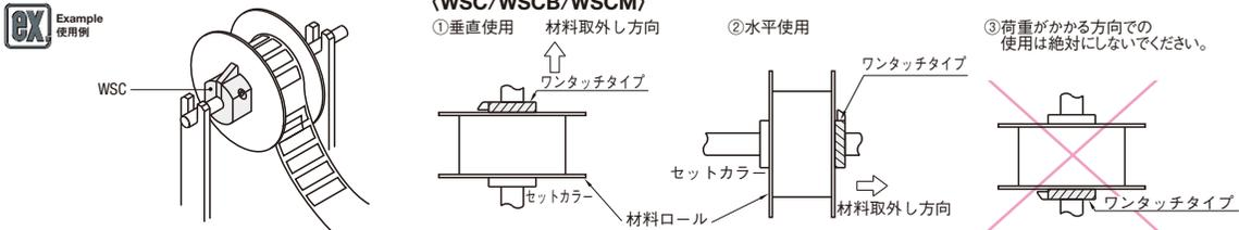
①垂直使用 ②水平使用 ③荷重がかかる方向での使用は絶対にしないでください。
