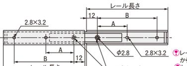
①レール収納時、引き出し側レールは固定側レールから2mm突き出た位置で止まります。
