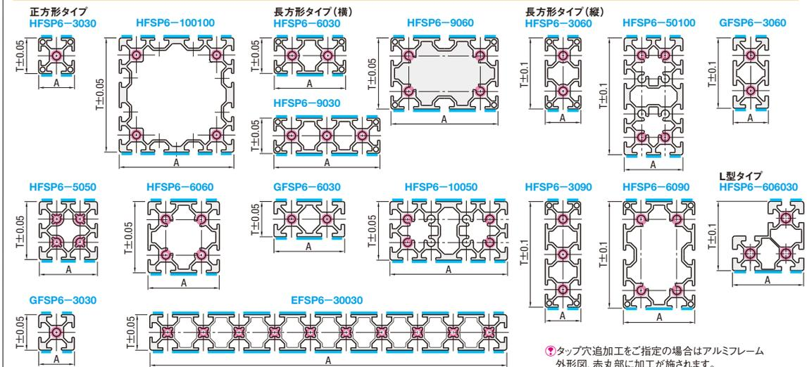
④ タップ穴追加加工をご指定の場合はアルミフレーム外形図、赤丸部に加工が施されます。
