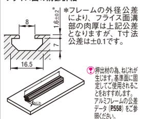
④ フライス面の溝部、A寸、T寸以外の詳細寸法、形状は、型式の「P」を外した商品の寸法図をご参照ください。(例) HFSP6-3030 → 参照図 HFS6-3030 (P.615)
