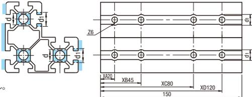
\*1 断面が長方形(縦)の場合、長手方向が60mmを超えるフレームにはザグリ穴追加加工を使用できません。
