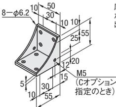
底面には溝にはめるための突起が0.8mm出ている。
