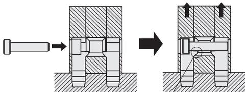
ジョイントパイプのテーパ部分と、後入れジョイントの突起部により、上方に引っ張る力が働き、フレーム同士を締結します。
