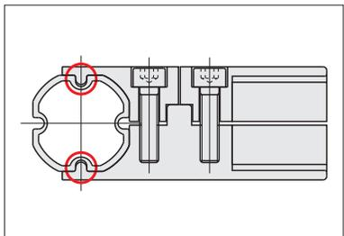
フレームの凹みとジョイントの突起を合わせることで、簡単にねじれなく組むことができます。
