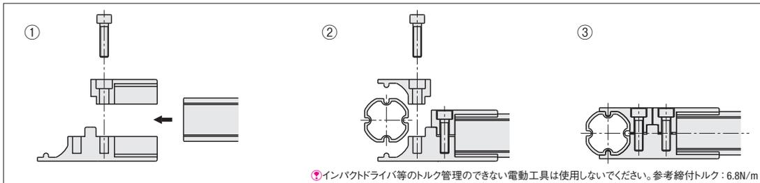
⚠インパクトドライバ等のトルク管理のできない電動工具は使用しないでください。参考締付トルク：6.8N/m
