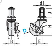
フレームへ差込後、六角部を専用スパナ(PFSP21別売り)で締めると、ゴムが膨らみパイプの内側から固定されます。
