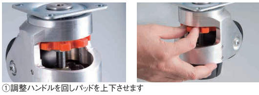
①調整ハンドルを回しパッドを上下させます
