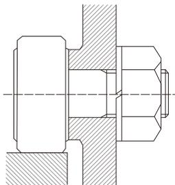
取付時、カムフォロアのつば部を直接ハンマーなどで叩かないでください。つば部が割れたり、回転不良の原因となります。六角レンチまたはマイナスドライバーで取付けてください。固定は、六角穴で固定してから、レンチでナットを回して締め付けてください。
