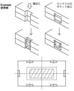
比較的大型サイズの金型では、モールドベース の長手方向に片側2セットずつご使用いただき ますと、より一層精密な位置決めができます。
