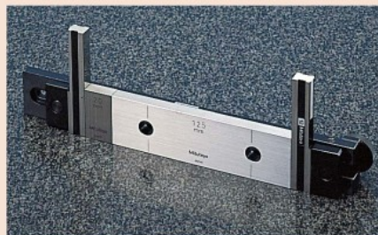
穴なしのゲージブロックと各種ジョウの連結例
