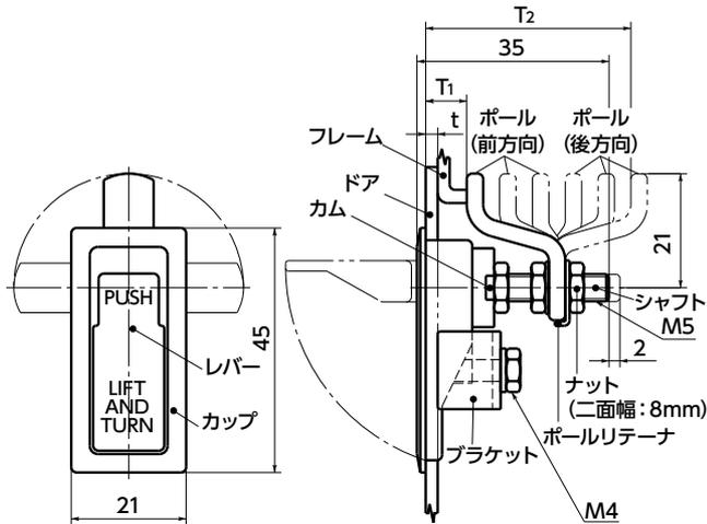
(付属のねじはドア厚さが最大3mmまで使用できます。ドアの厚さが3mmを超える場合は、ねじ長さがドアの厚さ+7mmのねじをご使用ください。)
