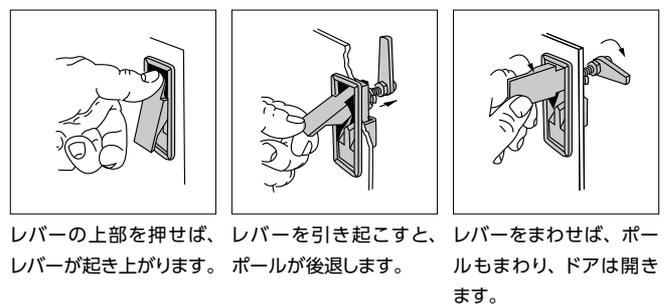
レバーの上部を押せば、レバーを引き起こすと、レバーをまわせば、ポールが後退します。ポールが後退します。ポールもまわり、ドアは開きます。
