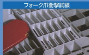
格子リブ一体構造のため破損無し
