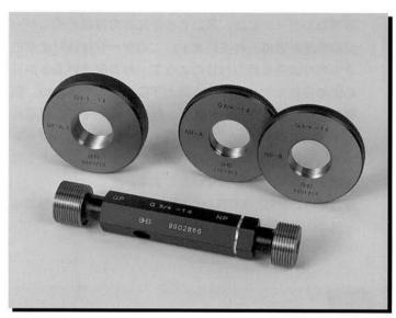
ISOゲージ規格の導入により新しくJISに制定されたもので耐密性を必要としない機械的結合を主目的とするねじ(G)の検査に使用するねじゲージです。従来の管用平行ねじゲージPFとの相違点は、次の通りです。
