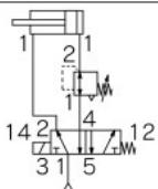
例2.エアの供給を停止し、レギュレータの入口圧力を大気開放する場合、安全対策上、レギュレータの出口側エアの残圧排気ができます。
