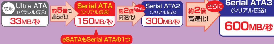
Serial ATAがシリアル伝送方式であることで、信号線が大幅に減少、ジャンパピンの設定が不要でドライブとマザーは1対1で接続されるようになります。(マスター・スレーブの区別がありません)
