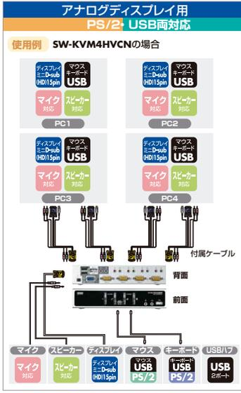
ディスプレイエミュレーション機能を搭載し、USB&PS/2コンソール両対応でUSB2.0ハブも共有できる。
