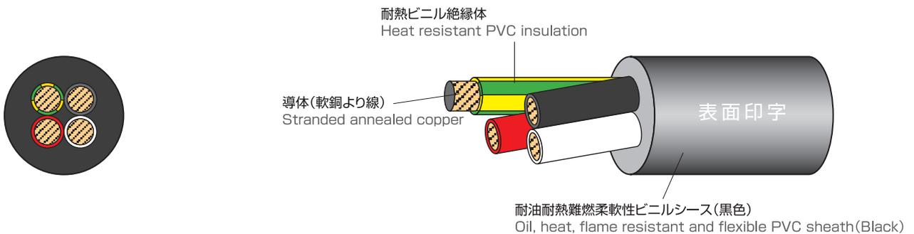
※10心以上はより合わせ上にテープ巻き / Cable with more than 10 cores : binder tape on cores.
