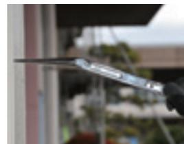
絶妙なシノ曲がり角度のため、穴合わせの際、シノ先の位置を確認しやすく効率良く作業が行えます。
