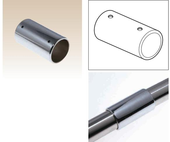
特徴 材質は亜鉛ダイカストで、クロームメッキ。止めねじ (M4) でパイプを外れにくくできる。
